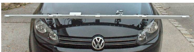
Abbildung 2: LimeCam Mess-Balken auf einem Messfahrzeug.
